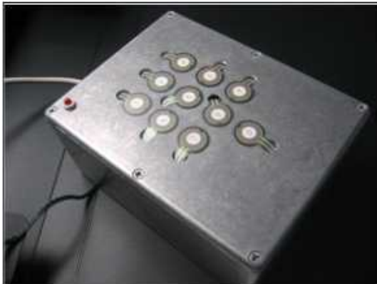
図1 半導体感圧センサを用いたテンキーパネル 暗証番号入力時の指先の押圧力を計測し、認証情報として付加することにより、暗証番号入力時の動画像が撮影などにより漏洩しても、視覚的には変化を捉えにくい堅牢な本人識別能力を維持することが出来る。
